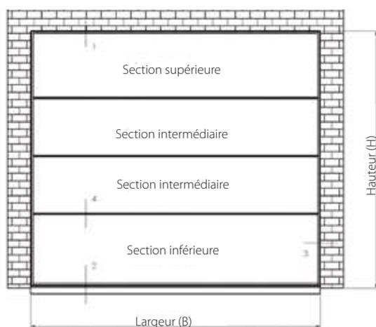
Pour une porte moyenne, on peut dire que la valeur U est égale à 1,0 W/m<sup>2</sup>K ; 1,4 W/m<sup>2</sup>K pour une porte sans fenêtre et 1,4 W/m<sup>2</sup>K à 1,8 W/m<sup>2</sup>K pour une porte avec fenêtre. En tout cas, la valeur U d'une porte sectionnelle de la gamme Section Line ne dépasse jamais la valeur U maximale admissible de 2,0 W/m<sup>2</sup>K prescrite par la norme PEB de la Vlaams Energie Agentschap, l'agence flamande de l'énergie.
