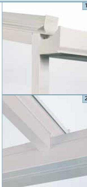
La couverture de terrasse Finstral se compose d'une armature en acier zingué. Les profilés d'acier sont ensuite habillés de profils PVC dur et le toit est recouvert côté extérieur d'un capotage aluminium thermolaqué. Cette combinaison garantit une construction solide et résistante aux intempéries.
