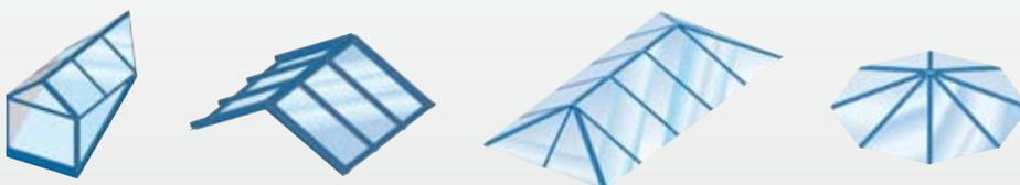
Exemples de typologies de lucarnes et toitures vitrées.
