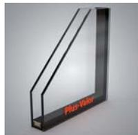
Nous équipons nos fenêtres en standard avec le double vitrage isolant Plus-Valor. Un des deux verres est revêtu d'un traitement faiblement émissif et l'espace entre les verres est rempli de gaz argon.
