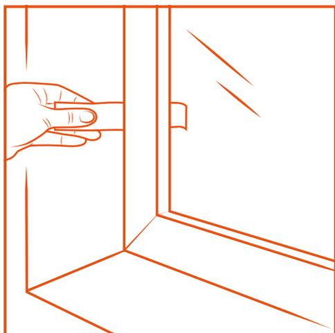
Ouvrez la fenêtre et coinciez la bande de papier n'importe où, en évitant toutefois les points de verrouillage. Refermez la fenêtre, et essayez de retirer la bande de papier. Répétez le test en plusieurs endroits.
